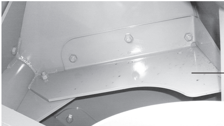
Bolt-in replaceable fan blade
