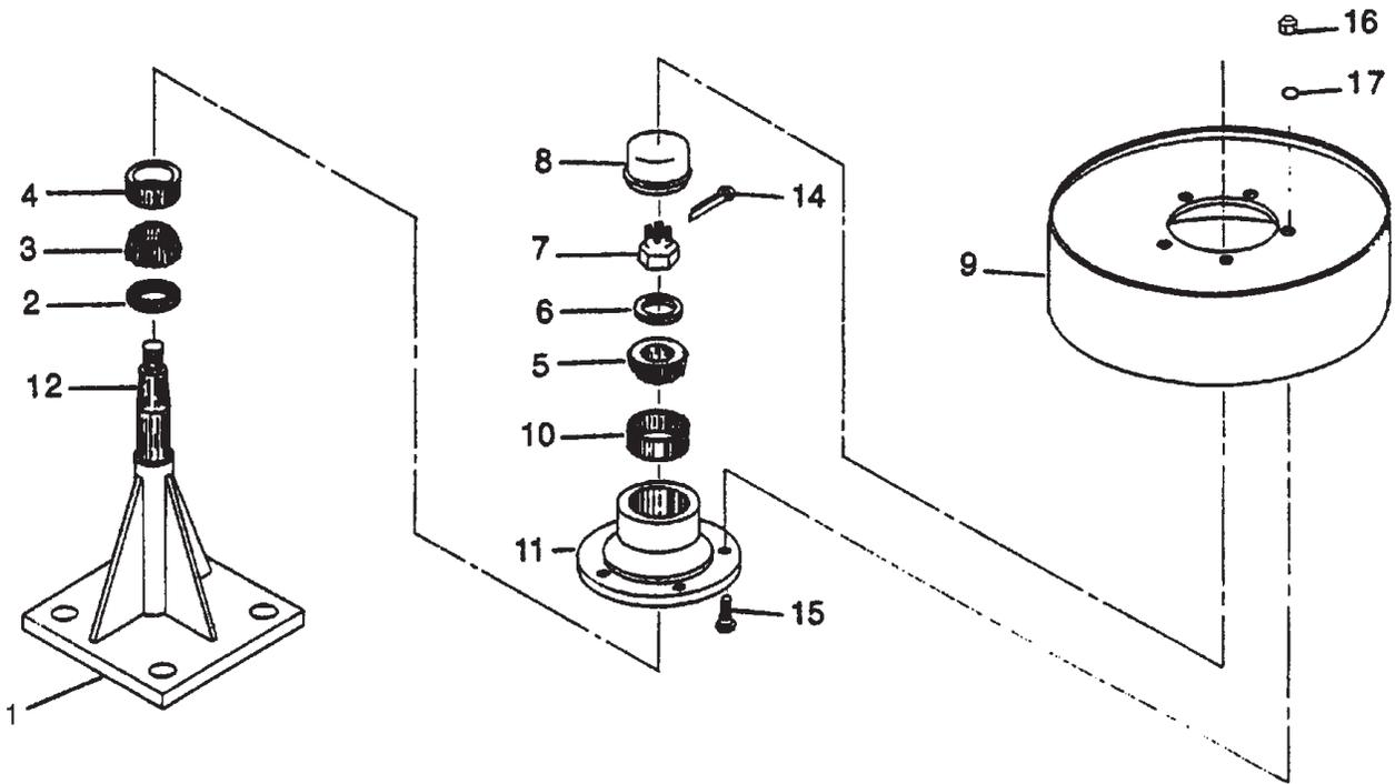
**PRESSURE ROLLER ASSEMBLY S.N. GI4002 & UP**
